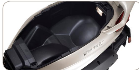
SITZKLAPPE MIT MECHANISCHEM HALTESYSTEM UND INNENBELEUCHTUNG
